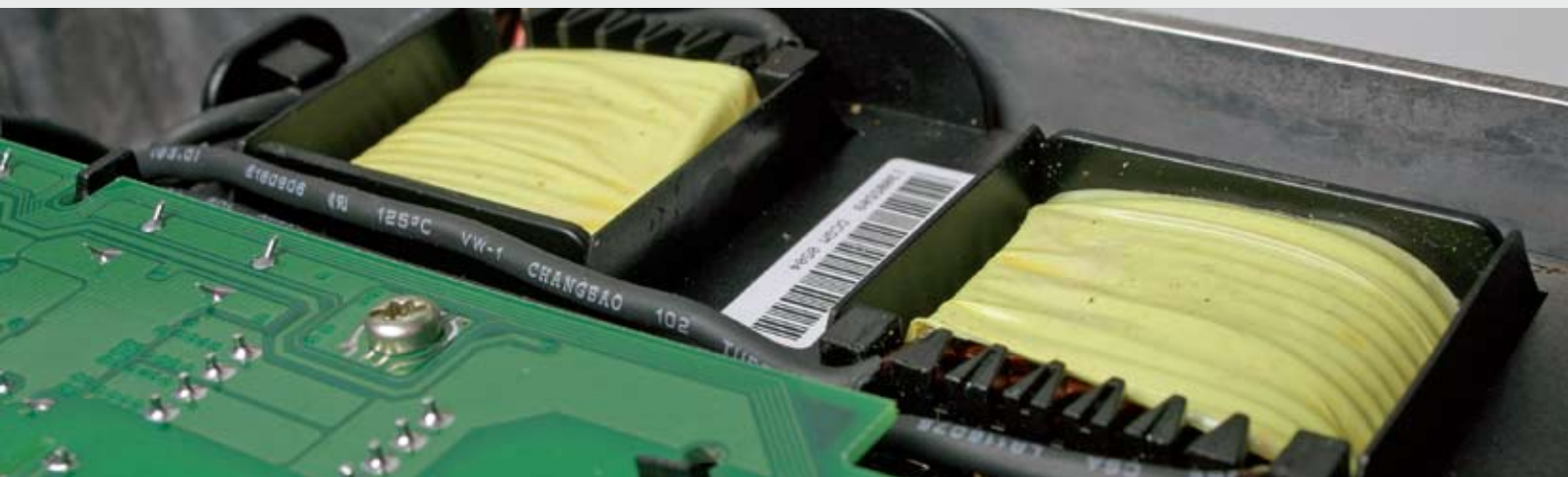
内置的中间电路电抗器可减少低频电网反馈，同时增加变频器寿命。
